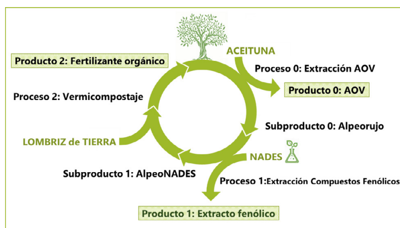
Figura 1. Diagrama de procesos para la economía circular en la producción de AOV. Proceso 0, extracción de AOV y generación de subproducto 0, alpeorujo; proceso 1, extracción de compuestos fenólicos del alpeorujo mediante NADES y generación de producto 1, extracto fenólico y subproducto 1, alpeoNADES; proceso 2, vermicompostaje del alpeoNADES y generación de producto 2, vermicompost, fertilizante orgánico.
